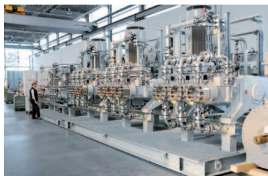
Hochdruck-Membranpumpen von LEWA: Für jede Branche und jedes kundenspezifische Einsatzszenario entwickeln die Ingenieure des Unternehmens spezifische Systeme.
